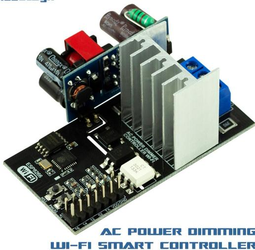
le jumper entre VDDet 3.3V doit être retiré pendant la programmation TTL puis remis lors du branchement de l'ensemble sur le 220V AC
