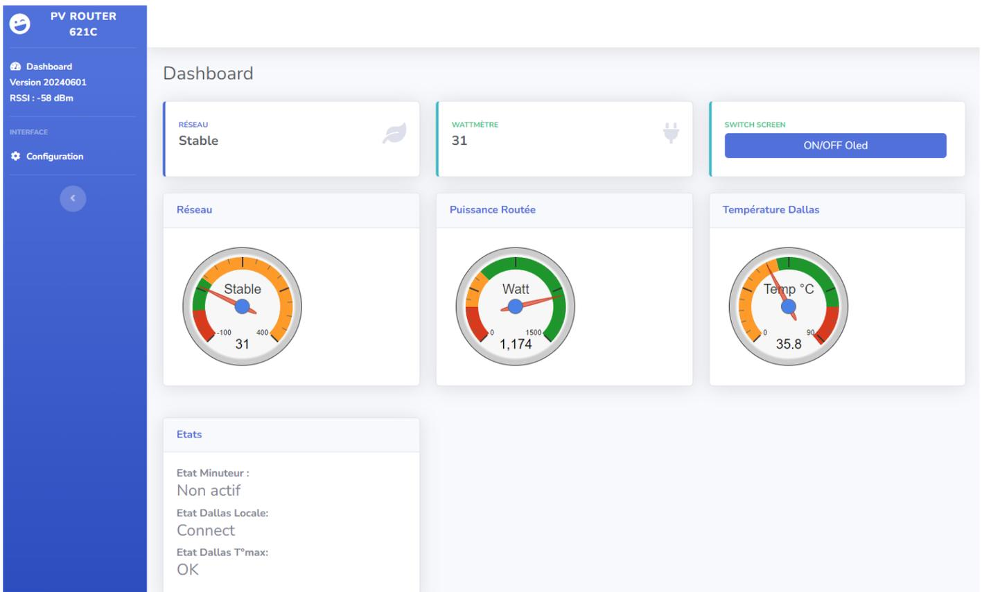
Sur cette interface vous retrouvez une gauge avec la puissance demandée au réseau (Sigma, en W), la puissance demandée aux dimmers ( en W ) et la température (en °C) remontée par la sonde du 1er dimmer si existante ( ou sonde présente localement ). Il indique aussi certains états du routeur.
