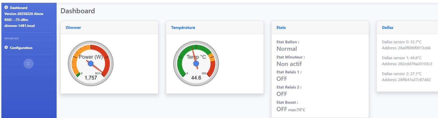
Sur cette interface vous retrouvez une gauge avec la puissance demandée aux dimmers ( en W ) et la température ( en °C ) remontée par la(les) sonde si installée, ainsi que des informations de surveillances
