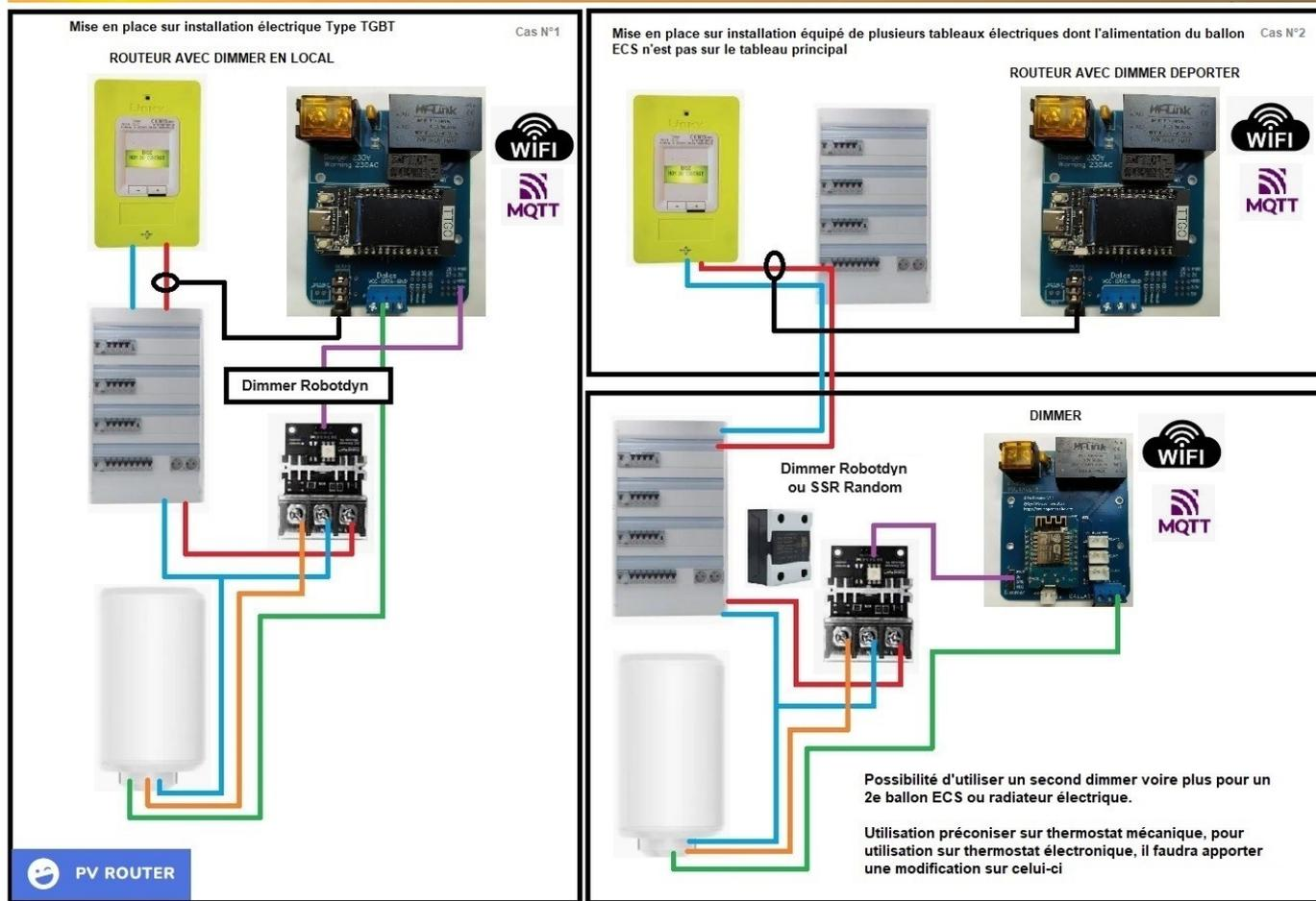
La carte a sa propre protection contre les surcharges (Fusible verre .15A ou automatique ) , mais il est conseillé de la placer derrière un disjoncteur ( 2A )
