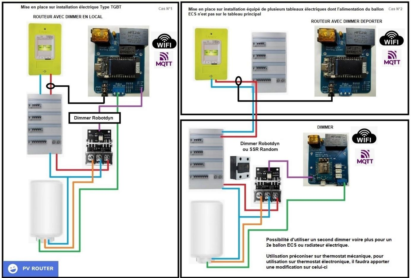
La carte a sa propre protection contre les surcharges (Fusible verre .15A ou automatique ) , mais il est conseillé de la placer derrière un disjoncteur ( 2A ) , mieux vaut trop de sécurité que pas assez.
