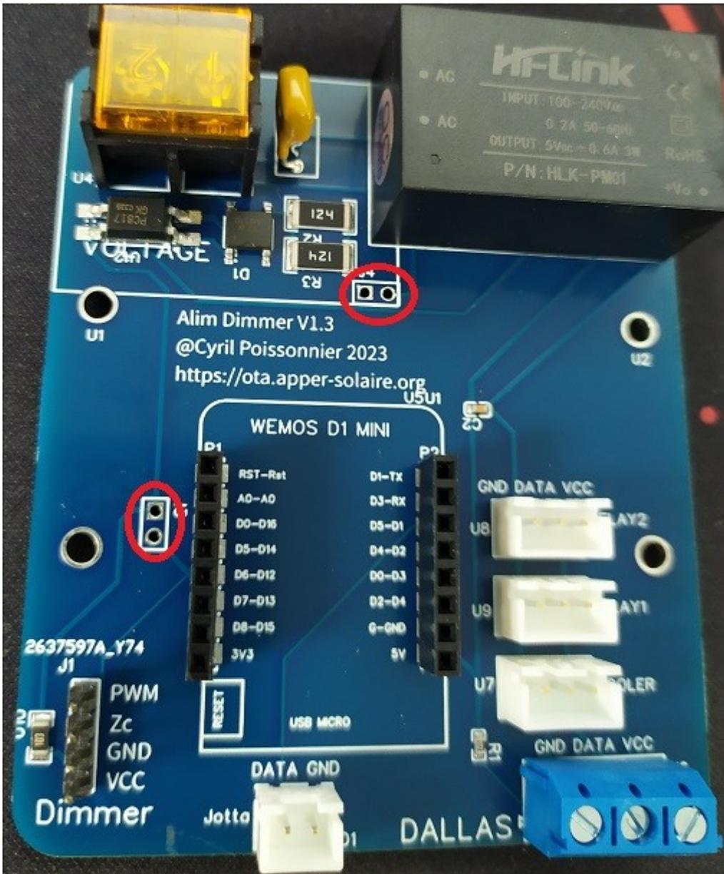
Les Jotta à utiliser sont des SSR DA et sa tension d'entrée est de 3V ( donc souvent 3-6VDC ou ou 3-32VDC )
